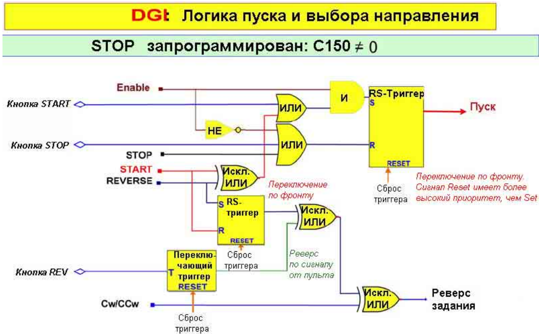
Рис. 49: Управление пуском и направлением вращения при наличии команды STOP .
