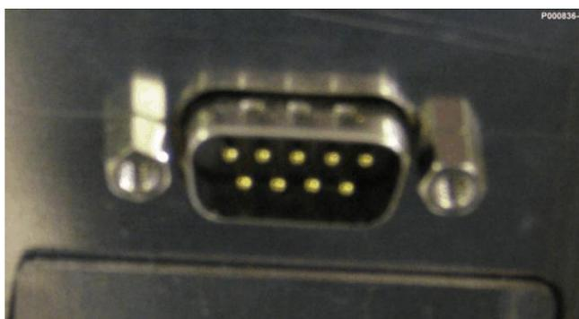
Рис. 44: Разъем DB9 порта COM1 в нижней части SUNWAY M PLUS.
