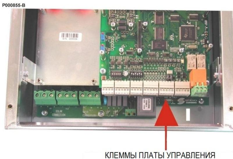
**Рис. 21: Расположение клемм платы управления.**
