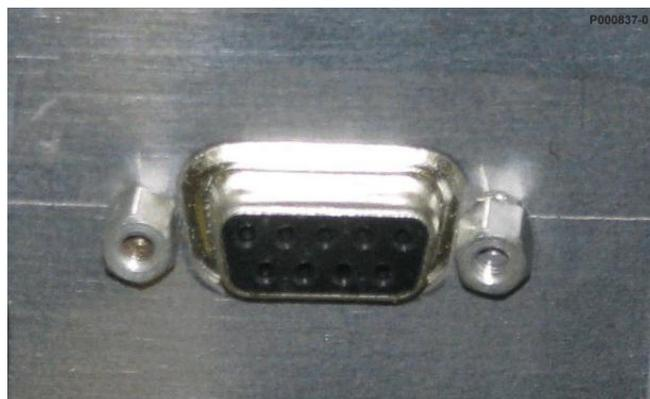
Рис. 46: Разъем DB9 порта COM2 в нижней части SUNWAY M PLUS.
