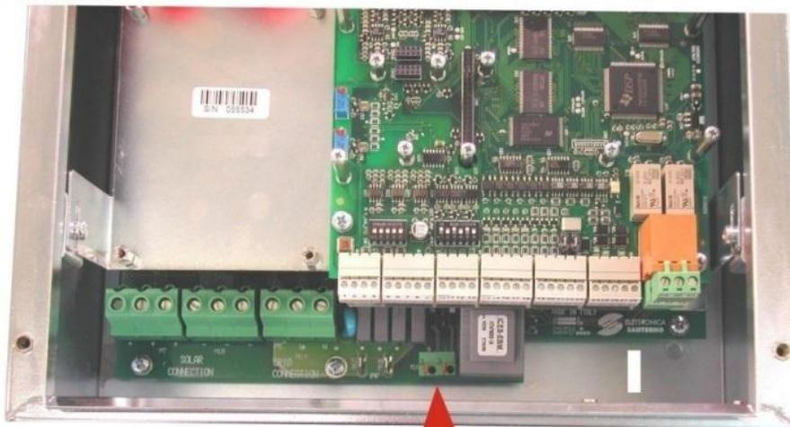
КЛЕММЫ ПОДКЛЮЧЕНИЯ ДАТЧИКА СЕТИ
