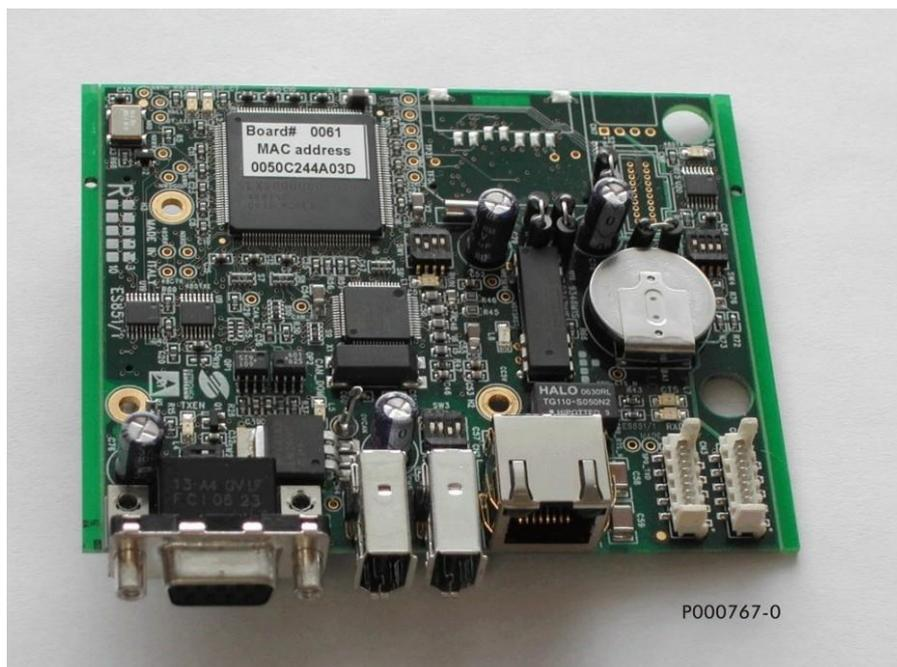
Рис. 40: Плата ES851 Data Logger.
